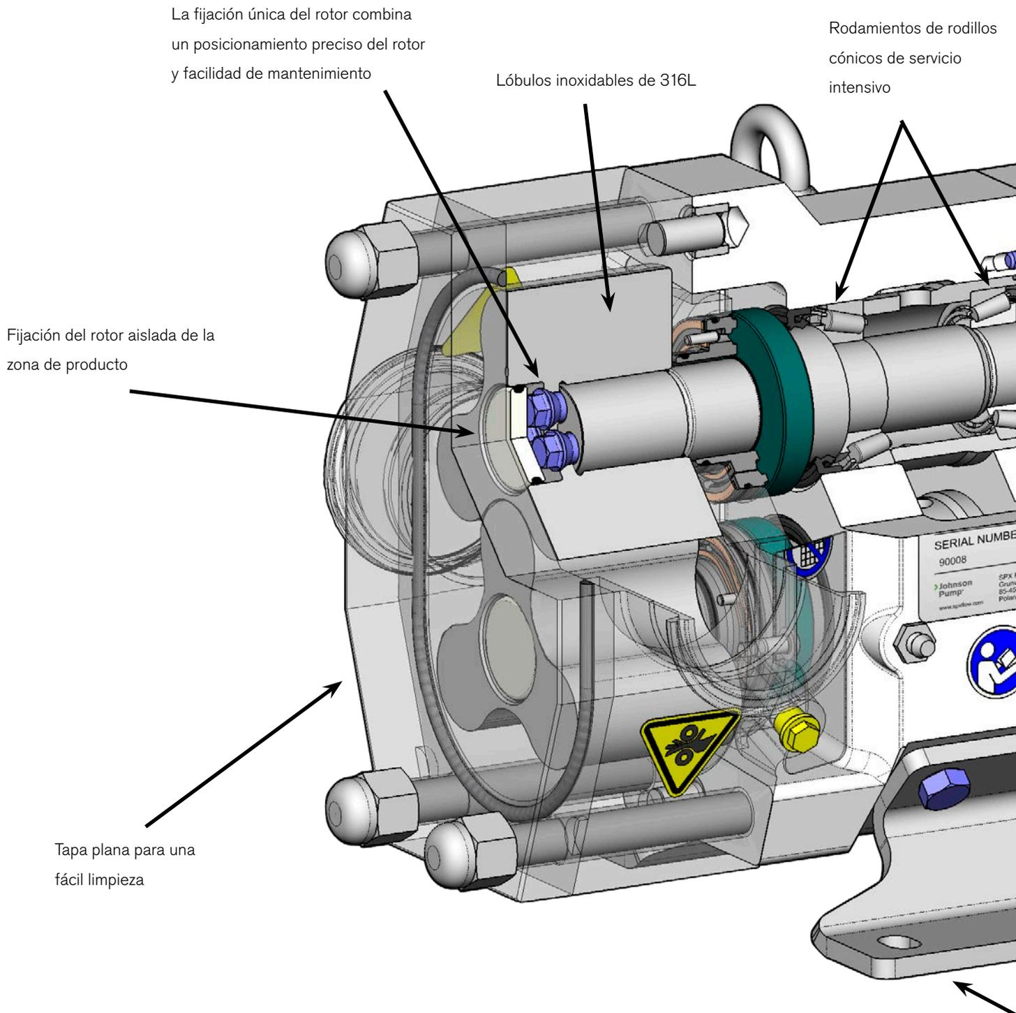
Fácil acceso a suplementos para el ajuste de la holgura del rotor
